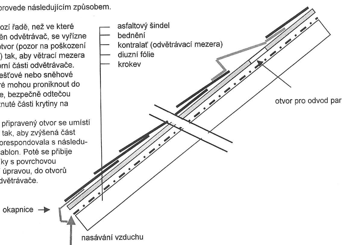
3. Mezi vodní drážku a zvýšenou část tvarovky se nanese dostatečné množství asfaltového lepidla, aby došlo k dokonalému spojení asfaltové krytiny a střešního odvětrávače. Potom se pokračuje s pokládkou další vrstvy tak, aby byla zachována dokonala nepropustnost střešního pláště.
