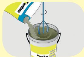
Webertop škrábána omítka se míchá pouze s čistou vodou cca 5l/30kg, vždy několik balení najednou pomocí UNIMIXERU – nástavce na vrtačku s pomalými otáčkami nebo míchačky s nuceným mícháním. Poměr vody se může výrazně měnit v závislosti na povětrnostních podmínkách! Při aplikaci na jádrové omítky je třeba podklad navlhčit. Jakmile je omítka jednou namíchaná a připravena k aplikaci není možné ji dodatečně redit přidáním vody. Ideální je zpracování strojní omítáčkou.
