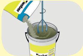
Webertop škrábaná omítka se míchá pouze s čistou vodou, vždy několik balení najednou pomocí UNIMIXERU – nástavce na vrtačku s pomalými otáčkami nebo míchačky s nuceným mícháním. Poměr vody se může výrazně měnit v závislosti na povětrnostních podmínkách! Při aplikaci na jádrové omítce je třeba podklad navlhčit. Jakmile je omítka jednou namíchána a připravena k aplikaci není možné ji dodatečně ředit přidáním vody. Ideální je zpracování strojní omítačkou.
