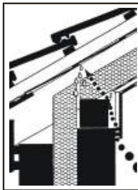
13 a) Detail okapu u větrané konstrukce střechy: parotěsné a vzduchotěsné vrstvy nejsou funkčně napojeny
