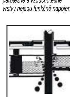
13 d) Průnik stavebních konstrukcí střešním pláštěm: parotěsné a vzduchotěsné vrstvy nejsou dostatečně těsně napojeny na pronikající konstrukce
